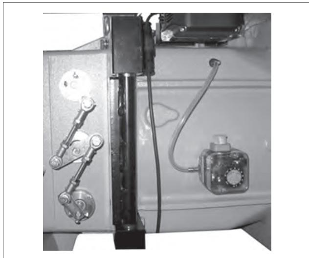
**Gaz basıncının kontrol manostatları** (minimum ve maksimum) gaz basıncı öngörülen değerler içinde olmadığı zaman, brülörün işleyişini engelleme amacına sahiptir.
