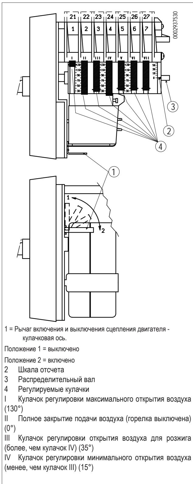
1 = Рычаг включения и выключения сцепления двигателя -
