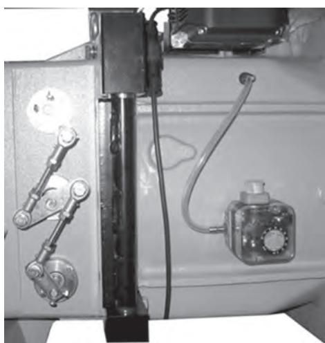
**Контрольные реле минимального и максимального давления газа** служат для того, чтобы не позволять работать горелке в тех случаях, когда давление газа не входит в предусмотренные значения.
