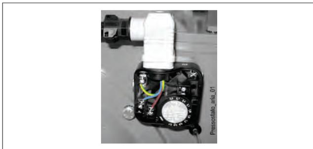
**Контрольные реле минимального и максимального давления газа** служат для того, чтобы не позволять работать горелке в тех случаях, когда давление газа не входит в предусмотренные значения.
